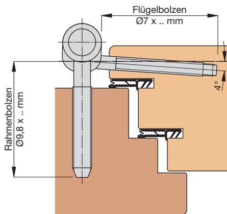
**Mit Dichtung im Überschlag - TOP320...S2, S3, S4, S6, S9**
