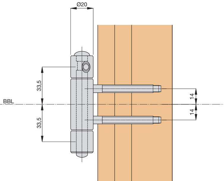
**Mit Dichtung im Überschlag - TOP320...S2, S3, S4, S6, S9**
